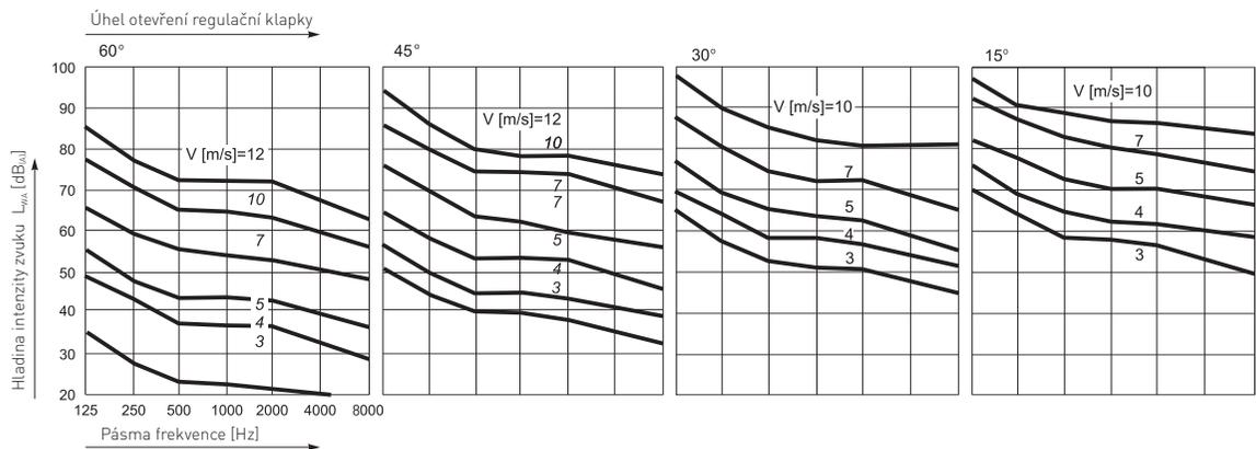
Na diagramech jsou uvedeny akustické údaje pro A = 0,1 [m<sup>2</sup>]. Pro jiné plochy průřezů regulačních klapek se k hodnotám uvedeným na diagramu musí přidat korekce „X“ podle tabulky:
